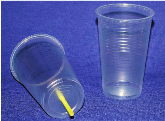
Ich habe in den Boden eines Plastikbechers ein Loch von 5 cm Durchmesser gebohrt und ein Stück eines Trinkhalms hineingeklebt.
